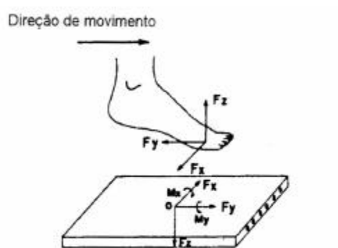
Figura 2. Decomposição da força atuante na superfície da plataforma de forças. Adaptado de Silveira Filho (1997)
