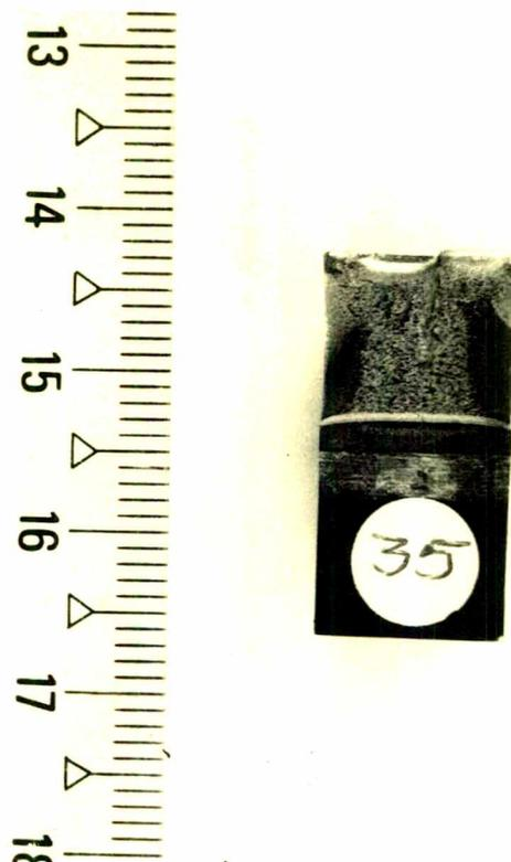
Fig. 2.10. - Corpo de prova de flexão em três pontos, com espessura  $B = 12$  mm.
