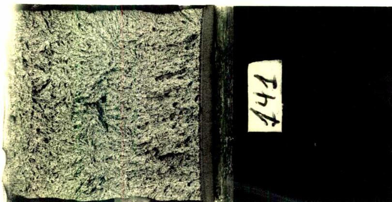
Fig. 2.8. - Corpo de prova de flexão com  $B = 30$  mm, revenido a  $400^{\circ}\text{C}$
