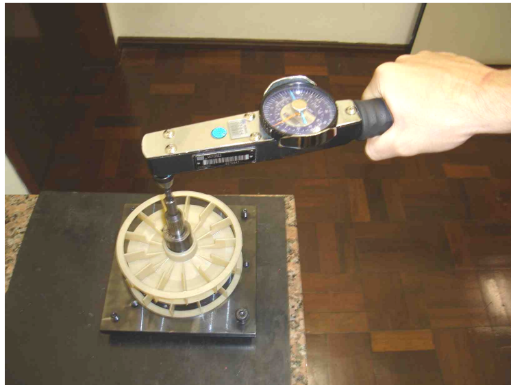
Figura 5.14 – Medição do torque resistente dos ventiladores.
