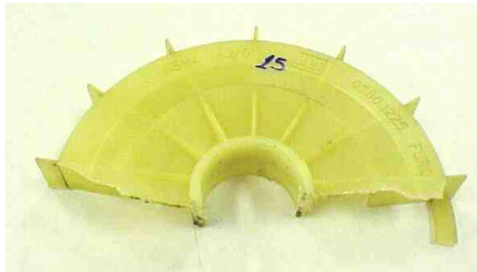
Figura 6.20 – Ventilador retirado do teste para análise após 350h à 80°C.
