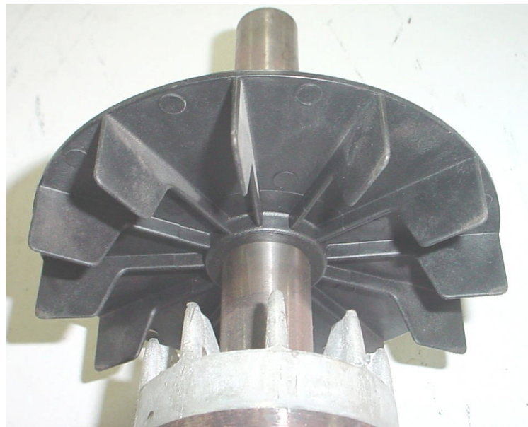
Figura 1.2 – Ventilador de Poliamida 6.6 com 30% de fibra de vidro fixo num eixo de 25 mm de diâmetro através de ajuste interferente. (Cortesia WEG Indústrias S.A.).
