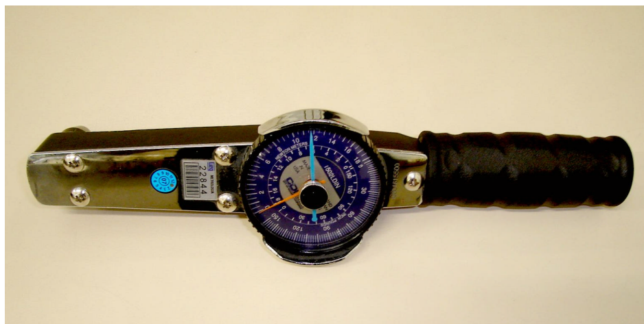
Figura 5.11 – Torquímetro analógico CDI modelo 3002LDIN – 50 Nm
