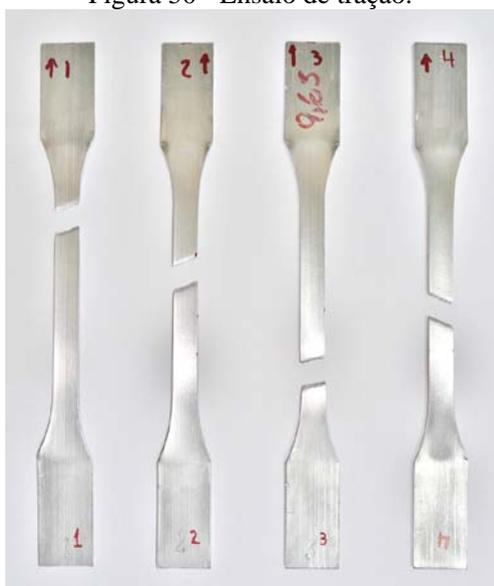
Figura 51 - Corpos de prova após o ensaio de tração.
