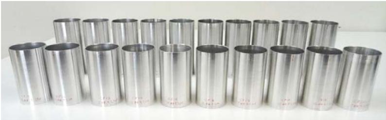
Figura 53 - Corpos de prova antes do ensaio de impacto.
