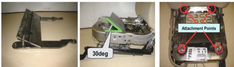
Figura 22 – Assento com rampa motorizada - *Motorized Seat Ramp* (NHTSA, D. O. T., 2013).
