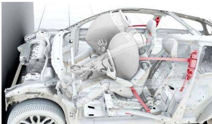
Figura 11 – Cinto de segurança de três pontos com pré-tensionador (Auto Průhonice - Volvo, 2014).
