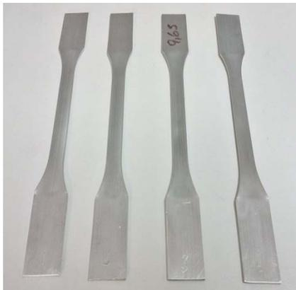
Figura 49 - Corpos de prova antes do ensaio de tração.
