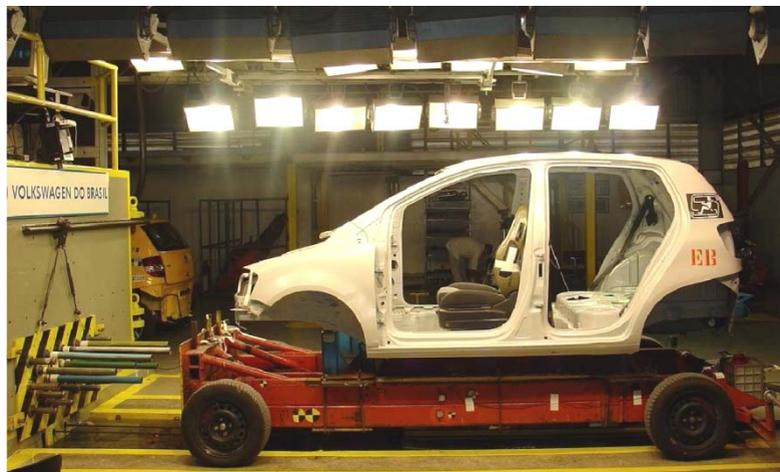
Figura 27 - *Sled test* utilizado pela VWB (Bugelli, 2005).
