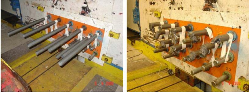
Figura 28 - Detalhe do sistema de parada do *Sled test* utilizado pela VWB (Bugelli, 2005).
