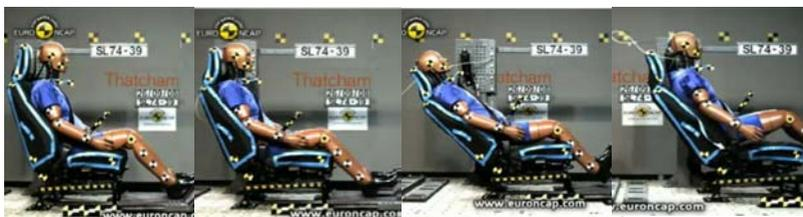
Figura 21 – Teste de encosto de cabeça (*whiplash*) do EuroNCAP (EuroNCAP, 2014).
