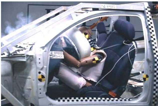
Figura 19 - Airbag em funcionamento (www.240km.com, 2014).
