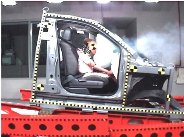
Figura 29 - *Sled test* com reprodução do efeito *pitching* (Instron, 2014).
