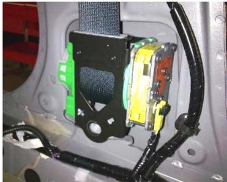
Figura 13 – Pré-tensionador do retrator.
