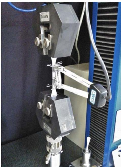
Figura 50 - Ensaio de tração.
