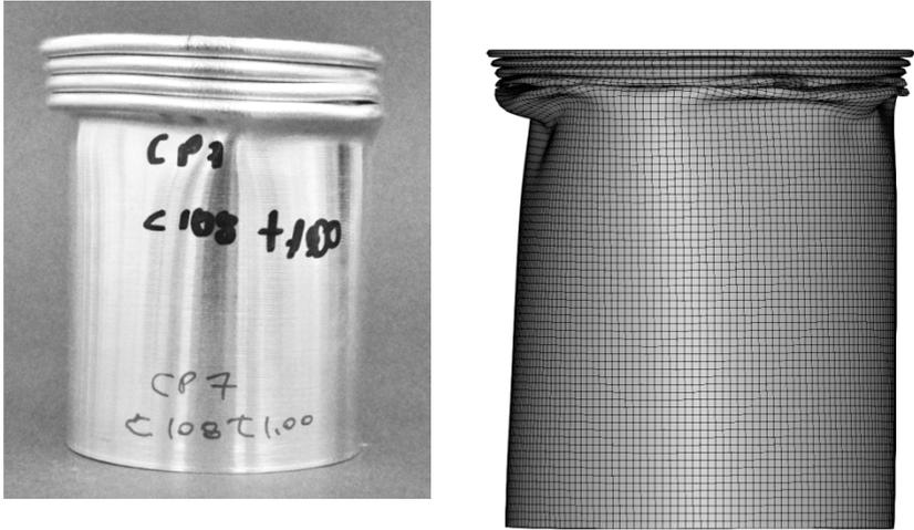
Figura 120 - Deformada experimental e numérica dos tubos.
